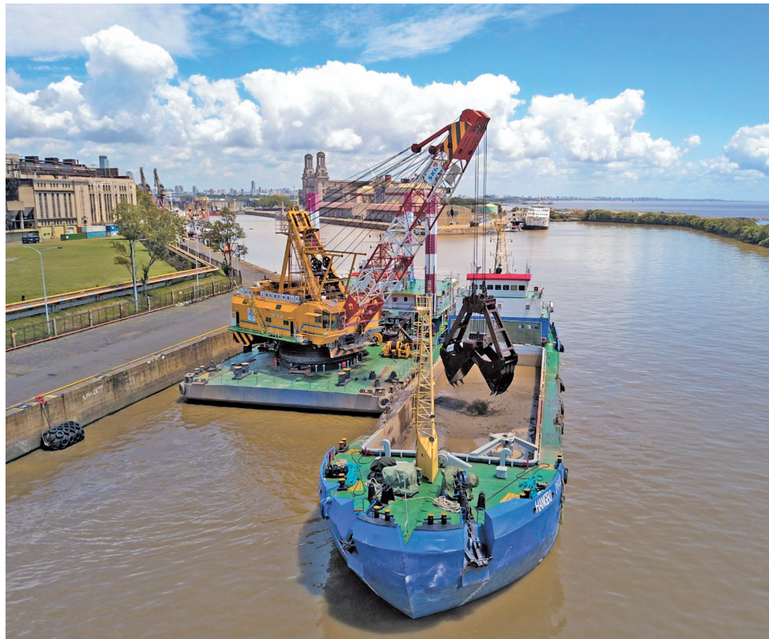
El dragado es la acción por la que se garantiza la profundidad necesaria para la navegación de los grandes buques.
